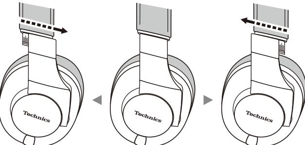
ヘッドバンドを水平方向にスライドさせることにより、最もフィットする位置に調整することができます。
