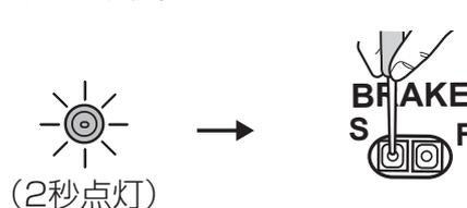
③ ブレーキボタンを押し終わったら、再び、設定している状態に合わせて確認ランプが点滅し、さらに2秒点灯後に終了します。
