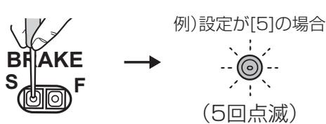
② その後、2秒点灯している間にブレーキボタンのFボタンまたはSボタンを押して、状態を変更してください。
