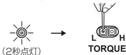
③ トルクボタンを押し終わったら、再び、設定している状態に合わせて確認ランプが点滅し、さらに2秒点灯後に終了します。
