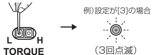
② その後、2秒点灯している間にトルクボタンのHボタンまたはLボタンを押して、状態を変更してください。
